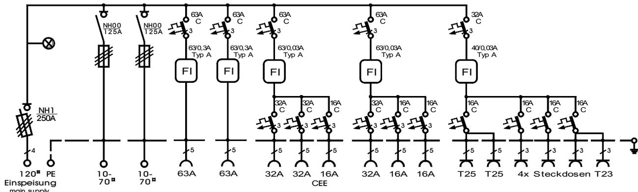
**DISTRO** - Verteilerschrank im Gehäuse aus verzinktem Stahlblech, pulverbeschichtet RAL 1021, bestückt mit:
