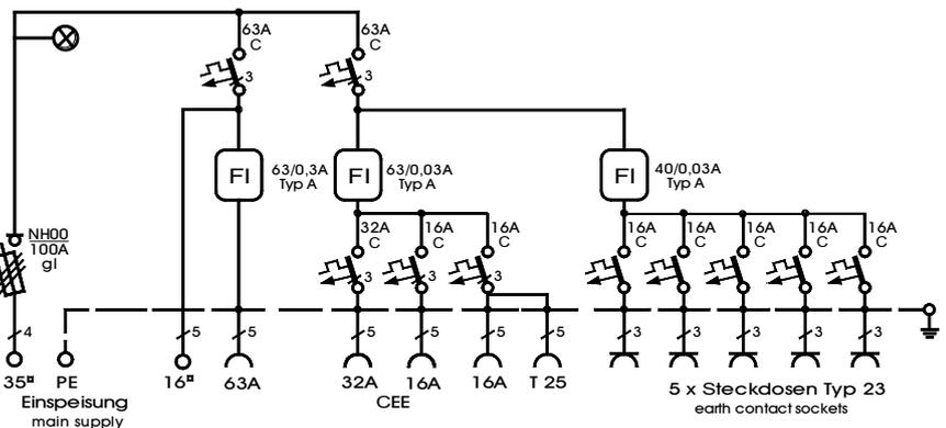
**DISTRO** - Verteilerschrank im Gehäuse aus verzinktem Stahlblech, pulverbeschichtet RAL 1021, bestückt mit:
