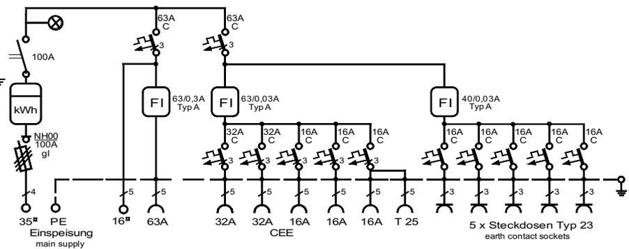
**DISTRO - Anschlussverteilerschrank im Gehäuse aus verzinktem Stahlblech, pulverbeschichtet RAL 1021, bestückt mit:**
