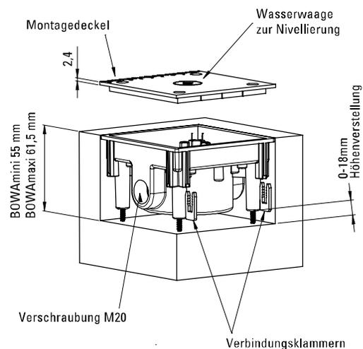
In das Leergehäuse 1632500 können alle nationalen und internationalen Unterputz-Systeme mit 80 mm Abdeckung und Tragringbefestigung aus der Installations- und Kommunikationstechnik eingebaut werden.
