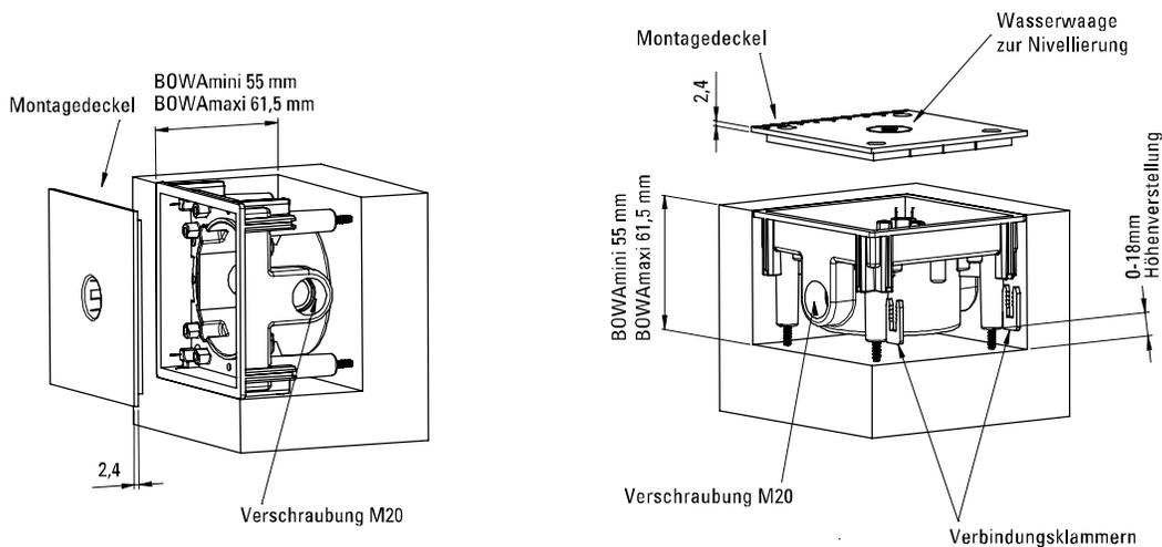
Für BOWAmini und BOWAmaxi liefern wir als Einbauhilfe einen Montagedeckel mit Wasserwaage sowie vier Stellschrauben für die Höhenverstellung mit. Mehrere Einbausteckdosen BOWA können Sie mit Hilfe von Verbindungsclips perfekt aneinanderreihen.
